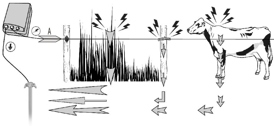
Der Strom zirkuliert von dem Elektrozaungerät, ausgehend durch den Zaunleiter, auf der Suche nach einer, in irgendeiner Weise möglichen, Rückkehr über die Erde.
